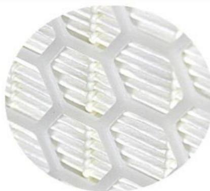
PARTICOLARE DEL SETTO FILTRANTE SPECIALE PER TURBOGAS
